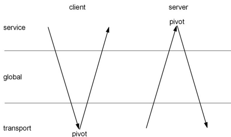
Die Pivots sind leicht erkennbar: bei diesen werden die Meldungen nicht einfach weitergeleitet sondern bearbeitet.
