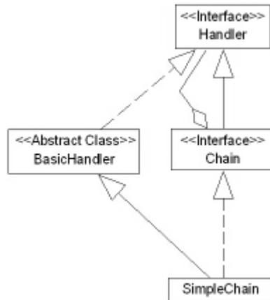
(das Diagramm lässt erkennen, dass eine Chain in etwa dem Design Pattern „Chain of Responsibility“ entspricht).
